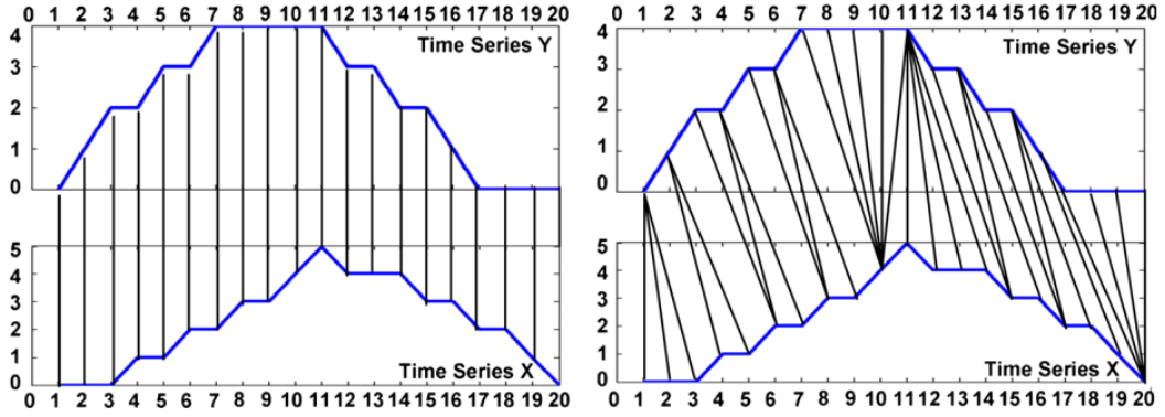
Gambar 2.1 Jarak euclidean (kiri) dan jarak DTW (kanan)
