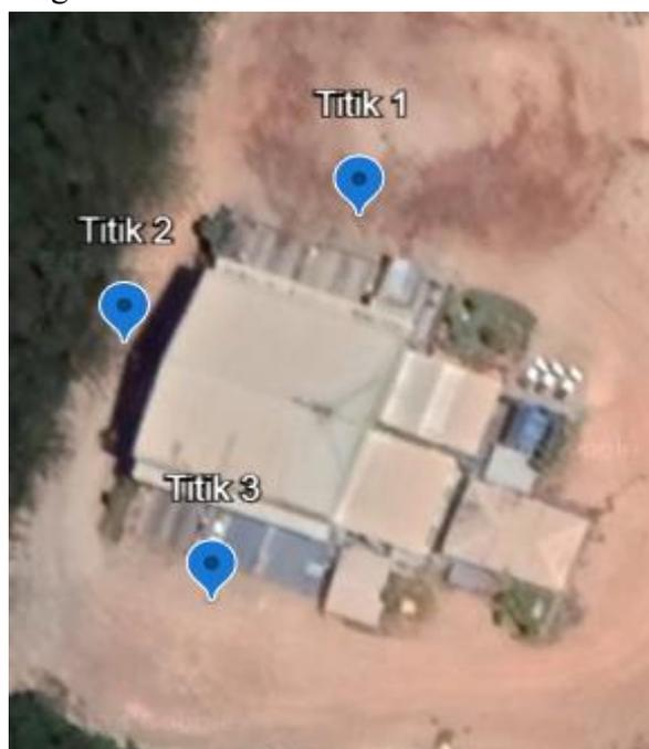
**Gambar 3.9** Titik-Titik Pengambilan Data Kebisingan Di area *Workshop Plant 1 Mobile & Track*
